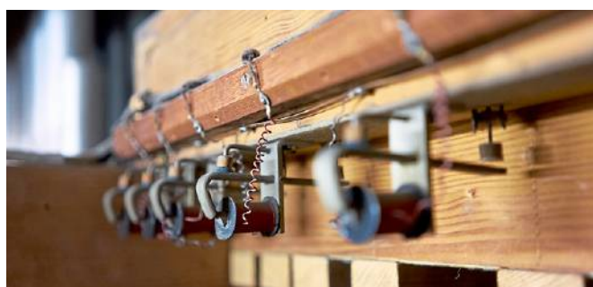
Elektromechanische Ventilsteuerung in der Opus 1052.
